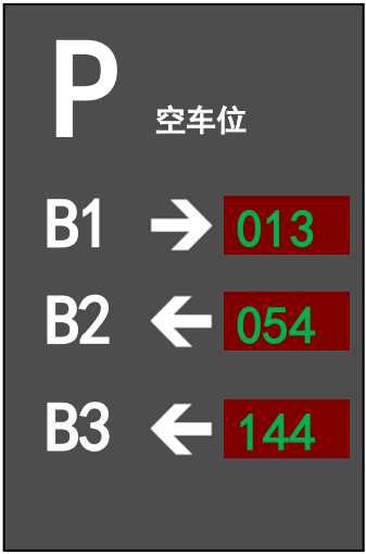
图B.13 剩余车位（空车位）标志牌示例 1
