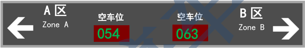
图B.14 剩余车位（空车位）标志牌示例 2
