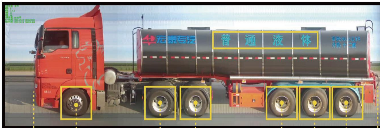
货车6型, 6轴, 1-2-3型, 非危化品车辆
