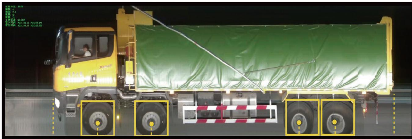
货车4型, 4轴, 1-1-2型, 非危化品车辆
